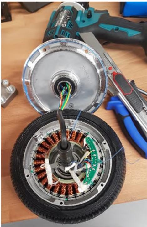
**Abb. 2 Im E-Scooter befindet sich der Elektromotor im Reifen: Die Magnete sind die silbernen Quader außen an den Kupferwicklungen.**
